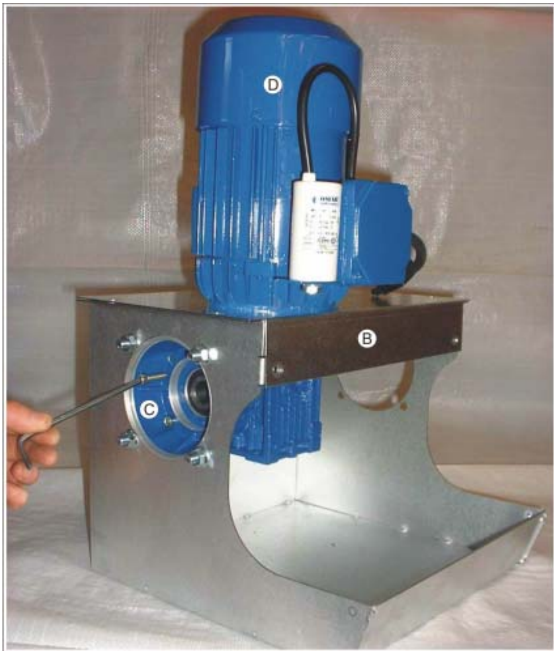
Figur 21: Montage av motor på utmatningslåda
